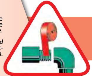
Per curvature inferiori a otto volte il diametro NON usare la fiamma ma aria calda soffiata.
