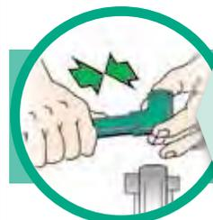
Assemblare le parti l'una nell'altra, senza ruotare e nel tempo ammissibile (tabella DV5 22007).
