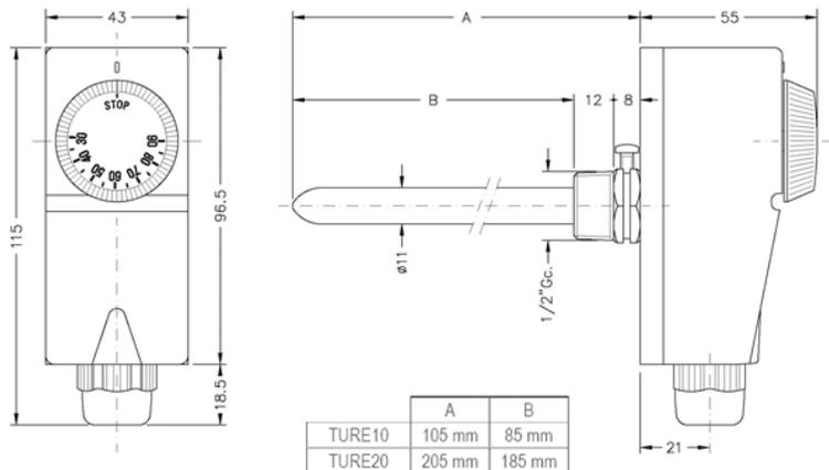
**TURE** è un termostato in scatolato unipolare, ad espansione di liquido, con contatti in commutazione; completo di passacavo. Particolarmente adatto alla regolazione automatica di caldaie, pompe e altre apparecchiature termiche. Il fissaggio del termostato è realizzato mediante pozzetto filettato da 1/2".
